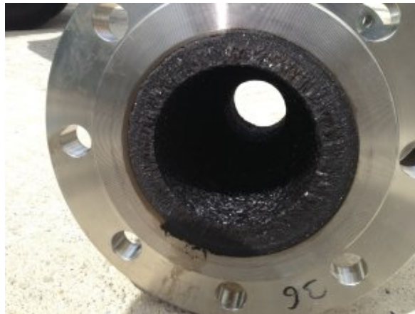
Scalings in an injection pipe (photo: Seitz-Gutmann)
