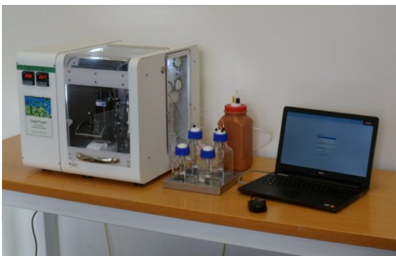
Microarray read-out device MCR Legiotyper (Image: GWK Präzisionstechnik GmbH).
