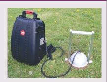
Echo (Halle A3, Stand 512) präsentiert ein tragbares Gerät für die simultane Messung von Kohlenstoffdioxid, Schwefelwasserstoff, Methan, Sauerstoff, Kohlenwasserstoffen und anderen Bodengasen. Verschiedene Sensoren messen die Gaskonzentration über einen dynamischen Bereich. Ein integriertes GPS-Modul bestimmt den genauen Standort der Messung. Über Bluetooth ist das System mit mobilen Endgeräten verbunden.
